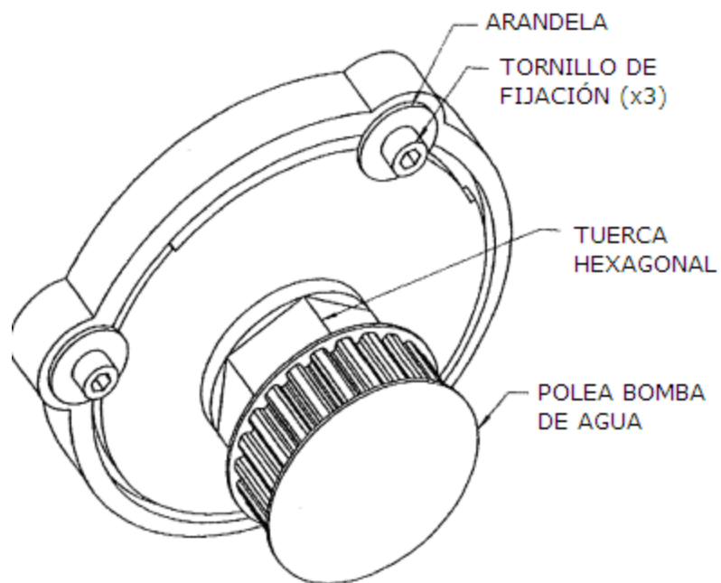
Figura 3: Cuerpo de la bomba de agua
